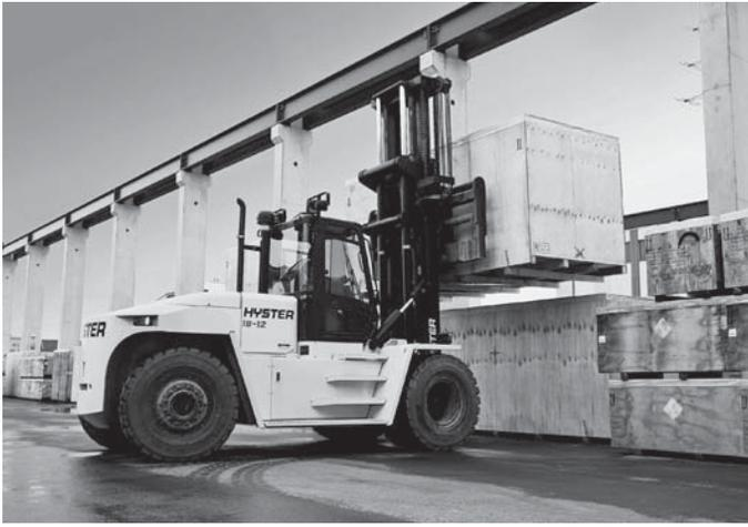
Cooijmans, der die Veranstaltung moderiert hat, ergänzt: «Abhängig von Nennlast, Arbeitszyklus und Anwendung werden mit den Hyster Staplern im Vergleich zu den Vorgängermodellen Kraftstoffeinsparungen von bis zu 15 % erreicht. In einigen Fällen lassen sich sogar Einsparungen um 20 % erreichen, was natürlich erhebliche Vorteile mit sich bringt.»
