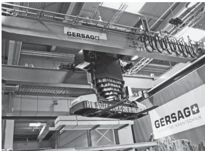
*Diese Zinken sind drehbar: Sie können unter einem Stapel ausgeschwenkt werden, was Fahrgassen obsolet macht.*
