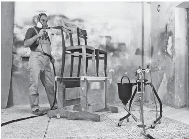
FineFinish 20-30 S AC ist auch als Spraypack auf Ständer mit starrem Ansaugsystem erhältlich. Durch den integrierten
