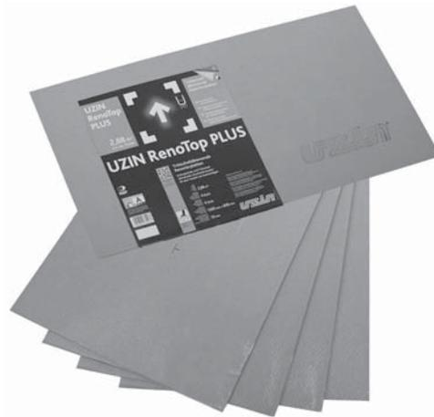
UZIN RenoTop PLUS ist ein mehrschichtig aufgebautes, entkoppelndes Unterbodensystem, das aus präzise gefertigten Träger- und Deckplatten besteht, die durch einen werkseitig applizierten Kontaktklebstoff dauerhaft miteinander verbunden werden. Somit hat der Verarbeiter die Möglichkeit, einen direkt belastbaren und belegbaren Unterboden ohne grosse Lärm- und Staubbelastungen herzustellen.
