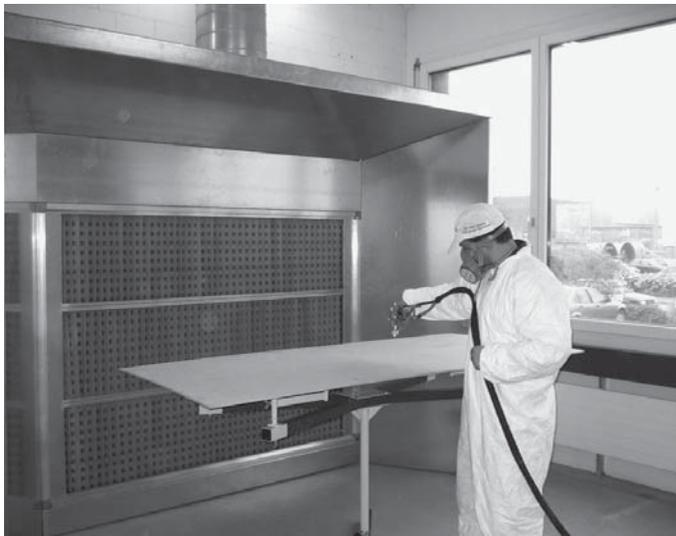
Mit einer grossflächig dimensionierten Absaugwand mit Filtersystem wird der Spritznebel (overspray) direkt erfasst, abgesaugt und filtriert. Die Filtereinrichtung sollte für alle anfallenden Farb- und Lackarten, aber auch Wasserlacke ausgelegt sein. Gleichzeitig wünscht der Kunde eine lange Betriebszeit und kostengünstige Ersatzfilter.
