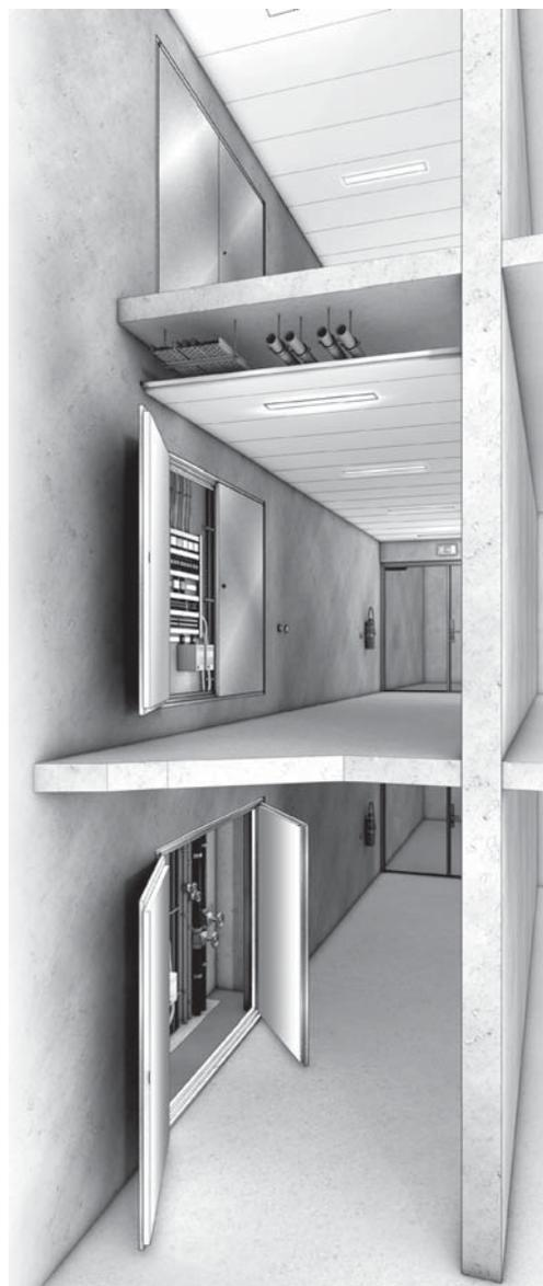
Für die Wartung und den Unterhalt werden Installationen zentral in Steigzonen geführt und der Zugang über Revisionsöffnungen sichergestellt. Diese Steigzonen befinden sich meist im Fluchtwegbereich (Korridor, Treppenhaus). Im Falle eines Brandes kann sich der Rauch sehr schnell über diese Wege ausbreiten. Um den Fluchtweg vor Feuer und Rauch zu schützen, sind die Steigzonen gegen den Fluchtweg hin mit geprüften Bauteilen (Wand und Revisionsöffnung) abzutrennen.
