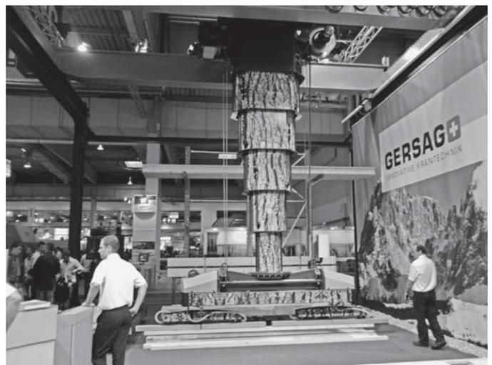
Mit einer Funkfernsteuerung steuert der Mitarbeiter den Stapelkran mit dem Vakuumhebergerät.
