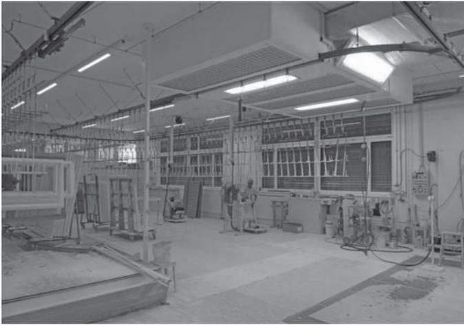
Tauchanlage, Fördersystem, Zuluftfilterdecke für Raumbelüftung.
