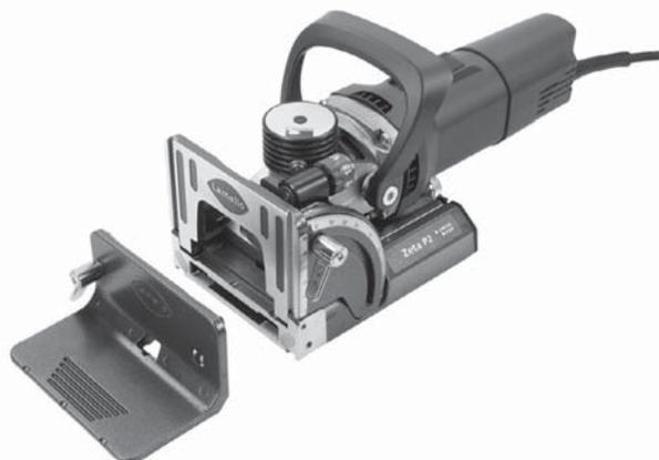
Die in die Zeta P2 integrierte Hubmechanik auf der Fräsespindel ist das Herzstück der Profil-Nutfräsmaschine. Beim Fräsvorgang führt die Hubmechanik automatisch eine seitliche Bewegung für die Profilmutter aus. Verbindungsbeschläge aller Art können nun von Hand in diese Profilmutter eingeschoben werden und schnell und formschlüssig verankert werden.
