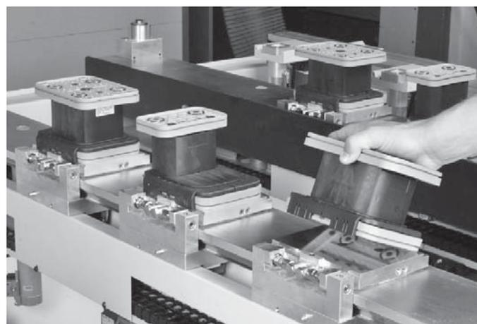
Bei der Weeke BHC500 der Raumin Marxer Friedrich AG lassen sich Konsolen und Vakuumsauger sehr zügig positionieren.
