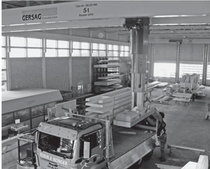
*Hightech in der Abbundhalle: Die Rubi Holzbau AG, Grindelwald, setzt den Stapelkran mit einem Zinkenträger ein.*
