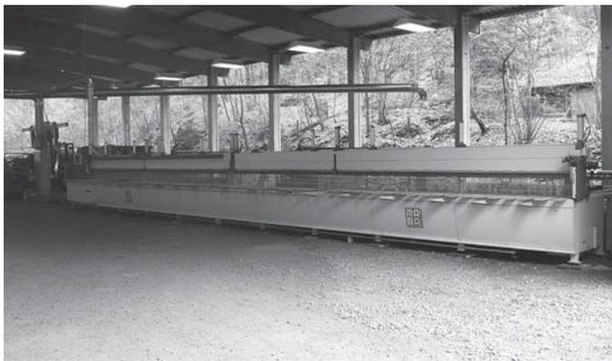
Alle MABA Längsschnitt-Kreissägen weisen eine Schnittbreite von 450 mm auf. Je nach Betriebsart sind auch Schnittbreiten bis zu 2500 mm einsetzbar. Alle MABA Längsschnitt-Kreissägen sind mit einer Schnitthöhe von 205 mm ausgerüstet. Optional kann die Schnitthöhe bis 300 mm erweitert werden.
