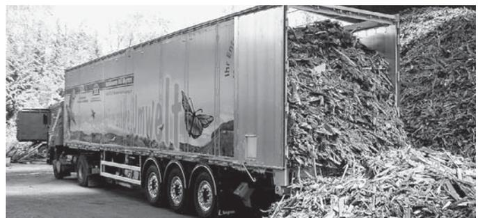
Die Konstruktion des gesamten Anhängers wurde auf einen verminderten Verschleiss, hohe Stabilität und daher eine hohe Lebensdauer ausgerichtet. Zum Beispiel ist die Auflagefläche der Gleitstücke um 35 % grösser als bei anderen Systemen. Auch sind die Seiten der Bodenprofile «eingezogen», damit die seitliche Befestigung der Kunststoff-Dichtungen nicht auf die Seiten der Profile wirken kann. Somit ist gewährleistet, dass sich die Schrauben nicht am gegenüberliegenden Profil berühren.
