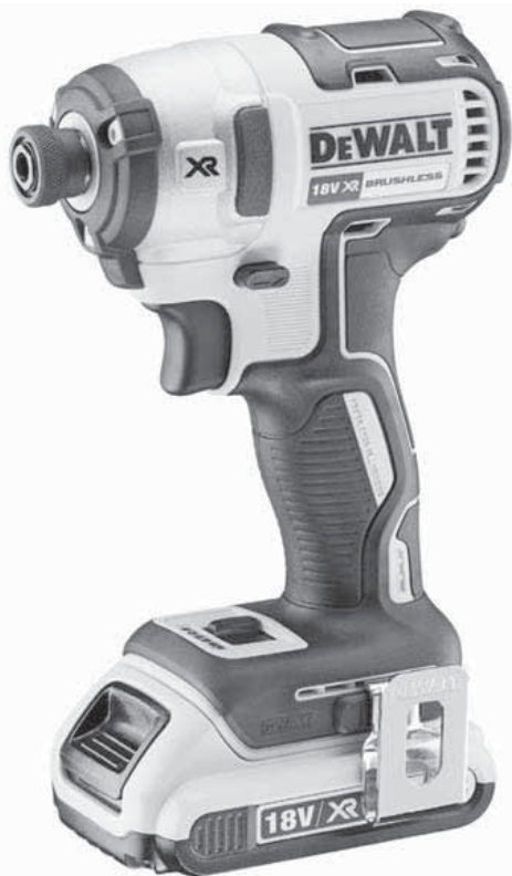
Der neue 18,0 Volt Akku-Schlagschrauber DCF 887 von DEWALT erzielt mit seinem bürstenlosen Motor ein max. Drehmoment von 205 Nm. In der 1/4"-Innensechskantaufnahme sitzen Bits besonders sicher und lassen sich dank leichtgängiger Drop & Load-Funktion mit einer Hand einfach und schnell wechseln. Fotos: DEWALT
