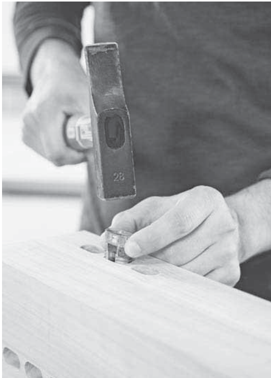
In den Pfosten wird der Spreizanker eingeschlagen, der sich beim Eindrehen des Ankerbolzens sicher im Material arretiert.
