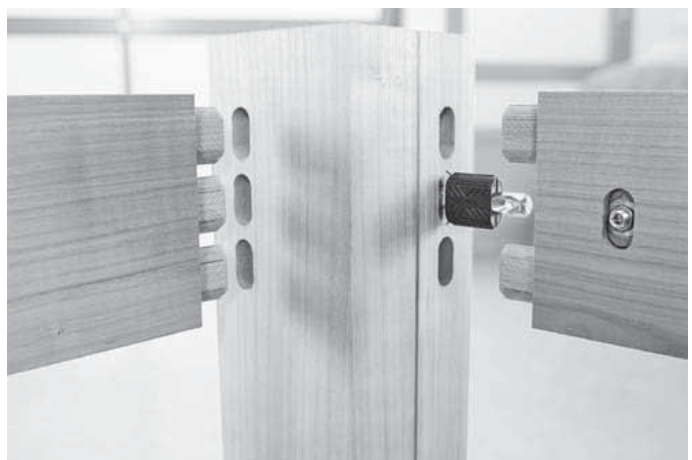
Über den Queranker wird die Verbindung gespannt und das Querloch – wenn gewünscht – mit einer Abdeckkappe abgedeckt (erhältlich in Silber, Hell- und Dunkelbraun).
