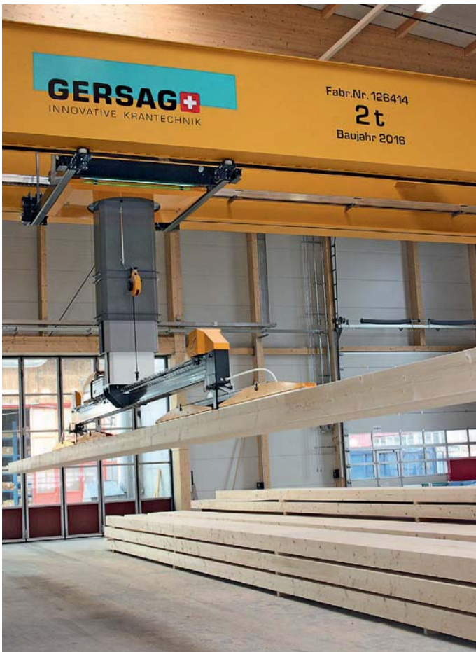
Der Stapelkran spart Platz und arbeitet schnell und rationell.
