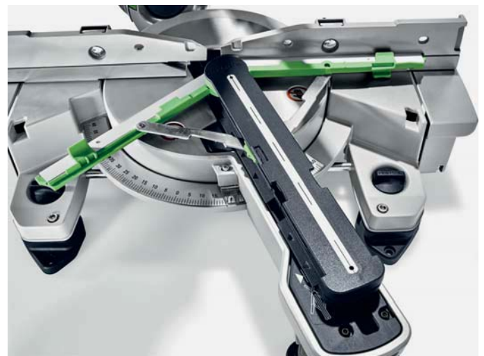
Mit der Winkelschmiege lassen sich sämtliche Innen- und Aussenwinkel präzise abnehmen und direkt 1:1 auf die Winkeleinstellung der Säge übertragen und damit winkelhalbierend einpassen.
