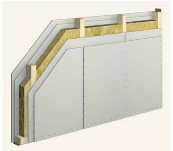
Der faserverstärkte Kern verleiht der neu entwickelten Riduro® Gipsplatte aussteifende Eigenschaften durch sehr hohe Festigkeiten. Bild: © by Renggli AG, Schötz
