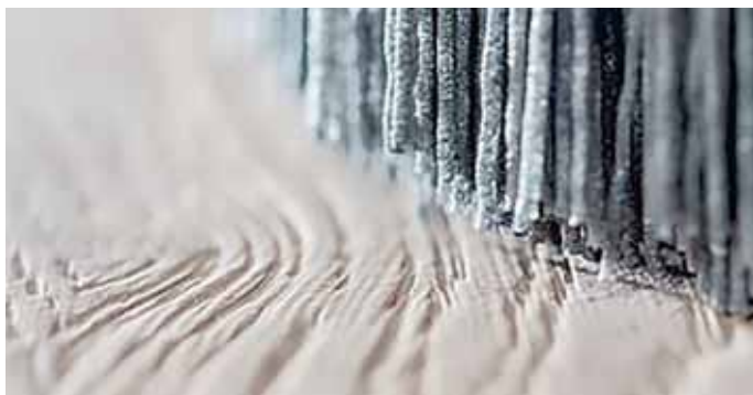
Durch die unterschiedlich harten Bürsten erhält der Parkettboden eine charakteristische Tiefenstruktur und ansprechende Optik.
