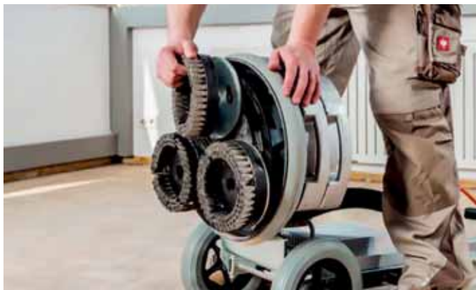
Die verschiedenen Bürsten lassen sich ohne speziellen Adapter auf die Parkettschleifmaschine DSW-400 montieren.
