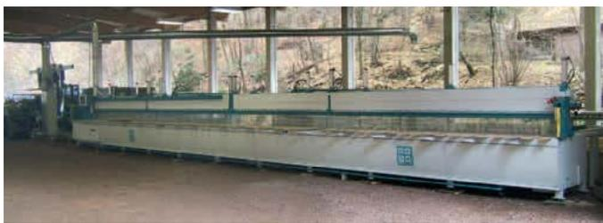
Alle MABA Längsschnitt-Kreissägen weisen eine Schnittbreite von 450 mm auf. Je nach Betriebsart sind auch Schnittbreiten bis zu 2500 mm einsetzbar. Alle MABA Längsschnitt-Kreissägen sind mit einer Schnitthöhe von 205 mm ausgerüstet. Optional kann die Schnitthöhe bis 300 mm erweitert werden.
