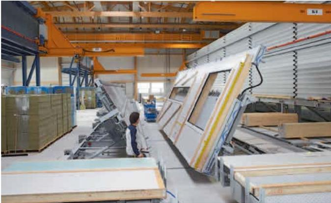
Mit der statisch wirksamen Riduro® Gipsplatte lassen sich die Verarbeitungsvorteile kartonummantelter Gipsplatten auch bei der Konstruktion tragender Wandelemente nutzen.
