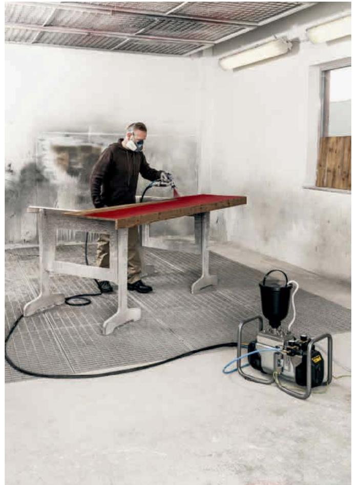
Einzigartig in der Branche: Die Abluft des IceBreaker-Motors klimatisiert Öl und Farbstufe, sorgt so für konstante Viskosität des Hydrauliköls und für eine konstante Leistungskurve. Die gleichmässige Motortemperatur bietet zudem einen erheblichen Vorteil bei der Verarbeitung temperaturempfindlicher Lacke.
